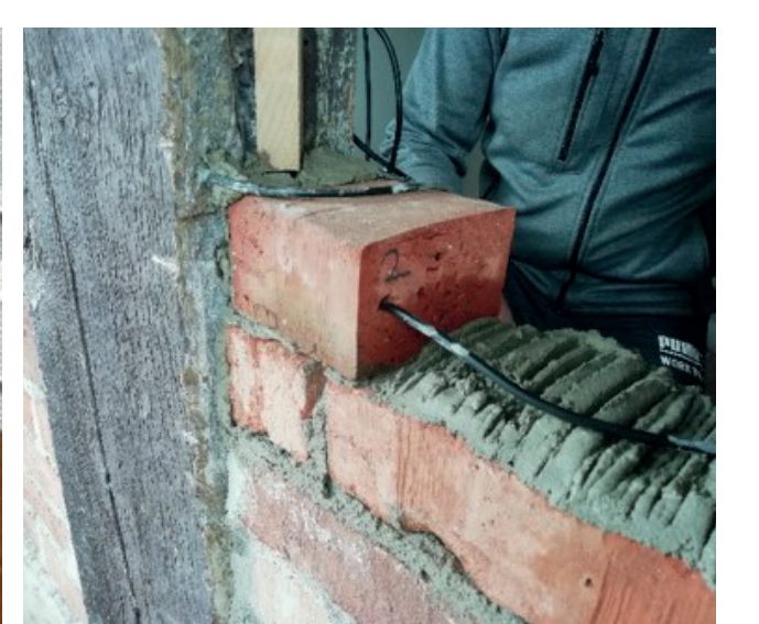
Einbringen der Feuchtemess-Sensoren
