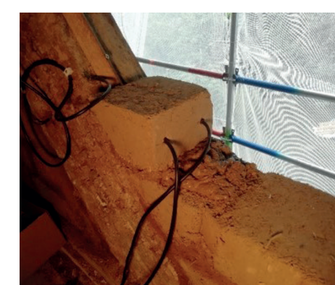
Einbringen der Feuchtemess-Sensoren
