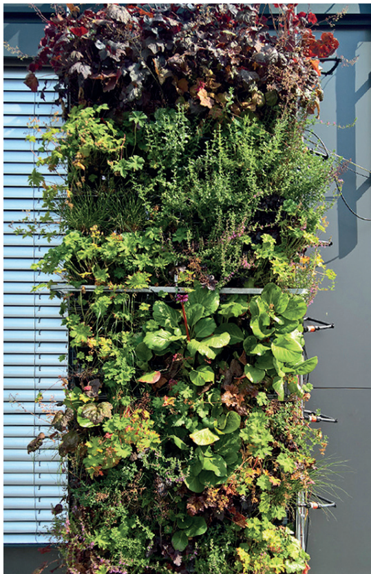
Abb. 51 Fassadenversuchsstand – Variante 3: Kramer, München mit Pflanzplan (THN-AR) (Pflanzliste vgl. Tab. A12 im Appendix)
