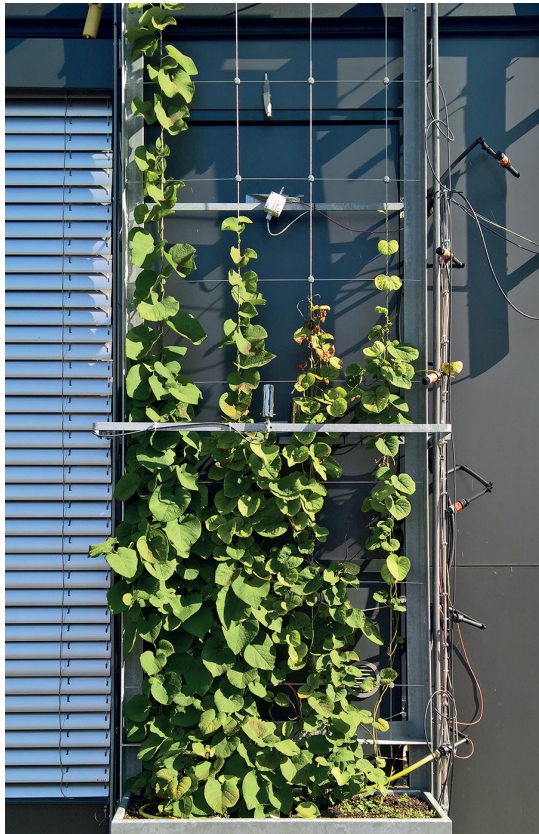
Abb. 52 Fassadenversuchsstand – Variante 4: Jakob Rope Systems, Ostfildern mit Pflanzplan (THN-AR) (Pflanzliste vgl. Tab. A13 im Appendix)
