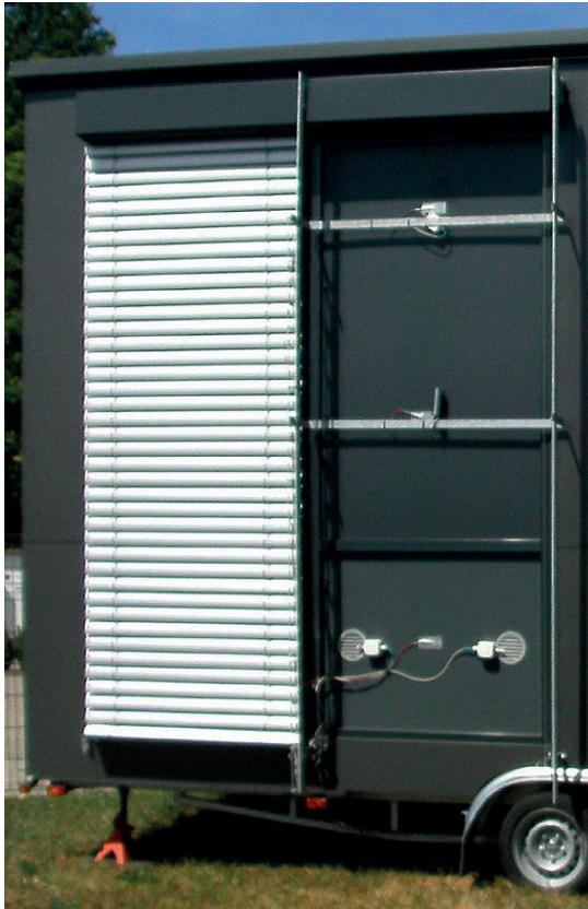
Abb. A27 Rednitzhembach, Technikum/ Fassadenversuchsstand – Referenzraum mit HPL-Platte (THN-ieg)
