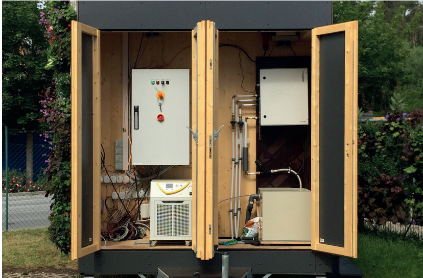
Abb. 48 Rednitzhembach, Technikum/ Fassadenversuchsstand, Technikraum – Bewässerungsanlage rechts (THN-AR)
