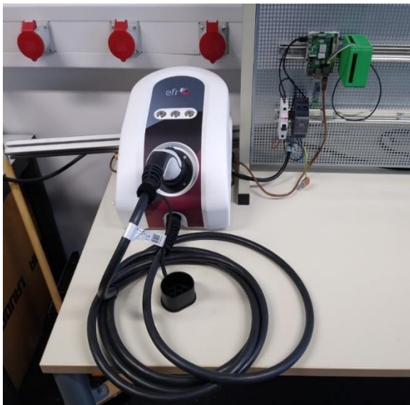
Abbildung 65: Versuchsaufbau für die Entwicklung und Testen der Ladesteuerung im Labor am EnCN
