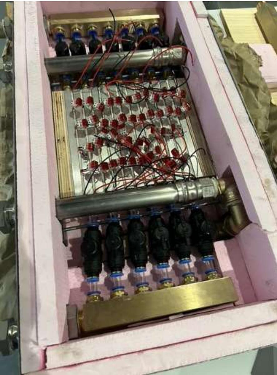
**Moduleinheit einer neu entwickelten thermoelektrischen Wärmepumpe mit Peltierelementen**
