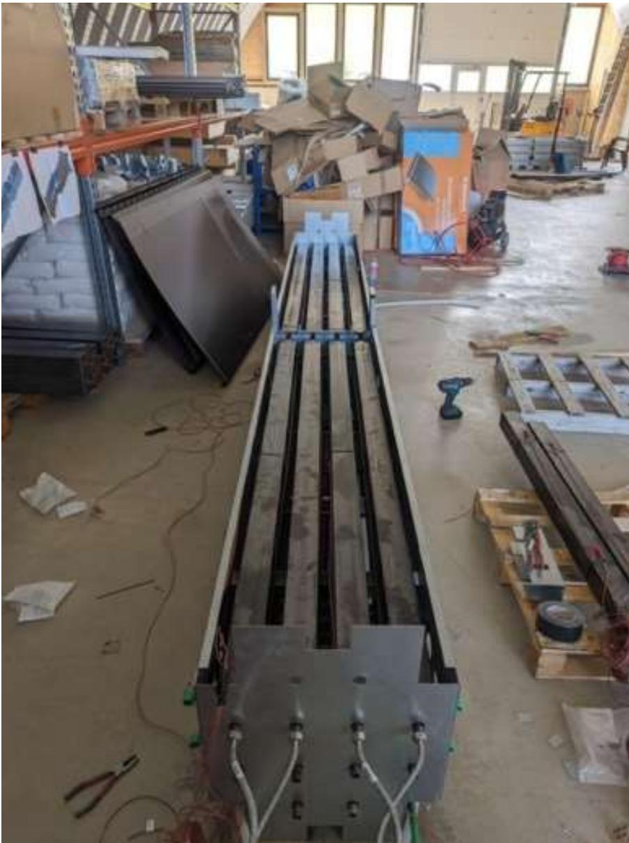
**Einbauteile für den Betonturm:**
