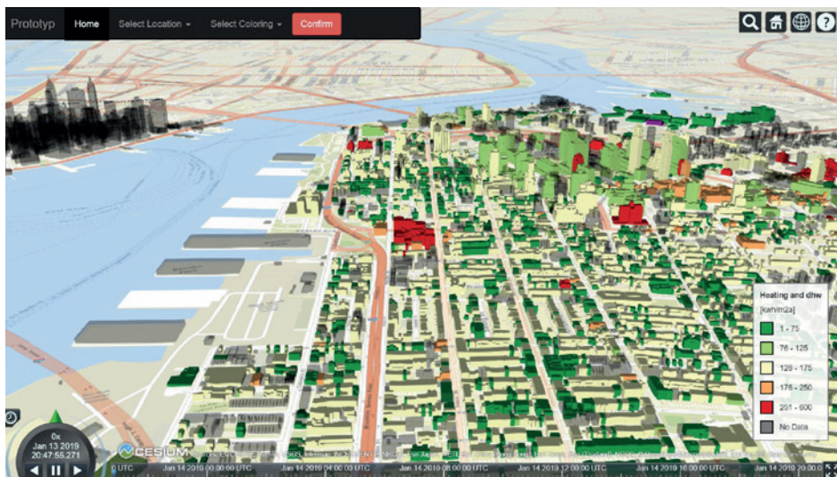
Abbildung 3: 3D Visualisierung des Wärmebedarfs Status quo in Brooklyn [Quelle: Zentrum für Geodäsie und Geoinformatik HFT Stuttgart]
