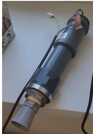
Abb. 5: Ultraschallsensor zur Messung des Wasserstandes (Eigenentwicklung)
