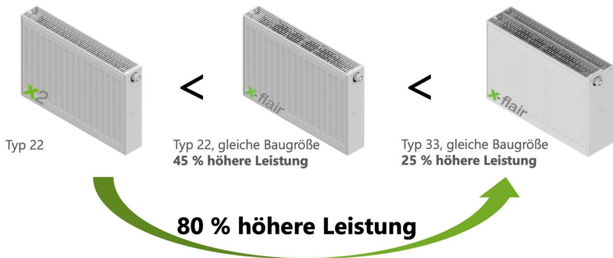
Abb. 7: Leistungserhöhung mittels Lüfterunterstützung (Systemtemperaturen 45/35/20 °C – ausgewähltes Beispiel)
