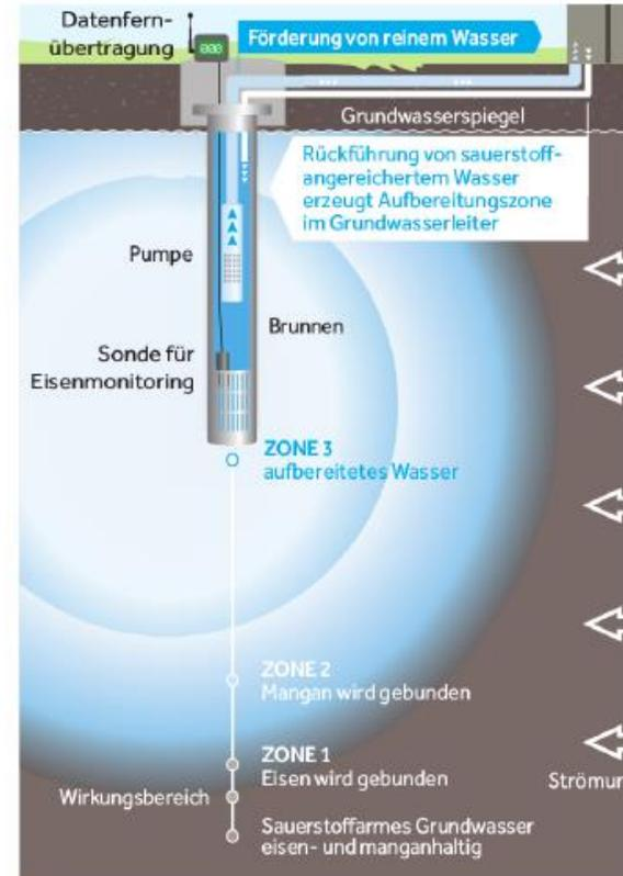
Abb. 3 – Schematische Darstellung der unterirdischen Aufbereitung bei Vorliegen einer Grundwasserströmung mit im Brunnen eingebrachter Sonde
