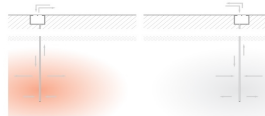
Aquifer-Wärmespeicher (30 bis 40 kWh/m 3 )
